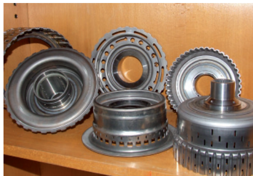
Verschiedene Schweißbaugruppen einer Kupplung
